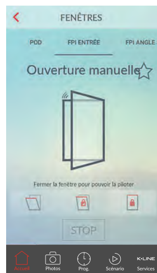
Fenêtre pilotée ouverte à la française pour nettoyage et maintenance (ouverture occasionnelle).
