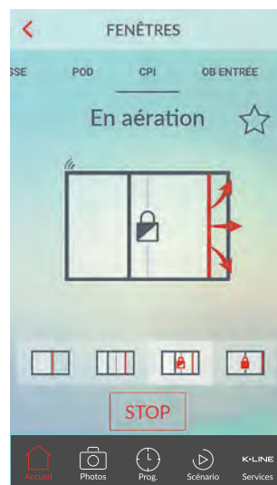
Coulissant Piloté en position aération sécurisée : le coulisant s'ouvre de 3 cm et se verrouille pour renouveler l'air ambiant en toute sérénité.
